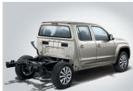
**Le châssis.** Si vous le souhaitez, les deux carrosseries et les quatre finitions standard de l'Amarok sont aussi disponibles sans surface de chargement. Vous obtenez ainsi un châssis polyvalent et robuste, pouvant être équipé de structures spéciales. Ainsi, les passages de roue, la ridelle arrière, les feux arrière, les radars et l'éclairage de la plaque ne sont pas présents sur le véhicule. L'Amarok n'obtiendra l'homologation de circulation qu'une fois assemblé par un carrossier spécialisé.
