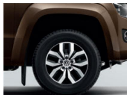
Les jantes alliage "Roca" 8 J x 17. Avec pneumatiques 245/65 R 17 en option sur trendline et pneumatique tout-terrain 245/70 R 17 de série sur Canyon.
