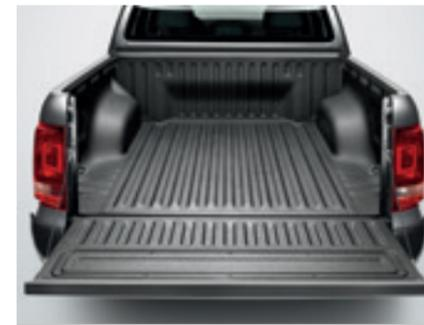
**Le revêtement pour surface de chargement.** Le revêtement en plastique anthracite résistant aux UV protège l'espace de chargement de tout dommage mécanique et chimique.
