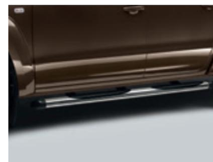
Les marchepieds. Les marchepieds en aluminium sont élégants et parfaitement intégrés à l'Amarok. Ils se fixent facilement grâce aux points d'ancrage prévus de série sur le véhicule. Aucun autre perçage n'est nécessaire. Capacité de charge jusqu'à 200 kg.
