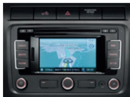
Le système de radionavigation "RNS 315" pour radio "RCD 310". Il est doté d'un écran tactile couleur, d'un kit mains libres Bluetooth®, d'une mémoire flash intégrée de 4 Go, d'un lecteur de carte SD et de six haut-parleurs, entre autres.
