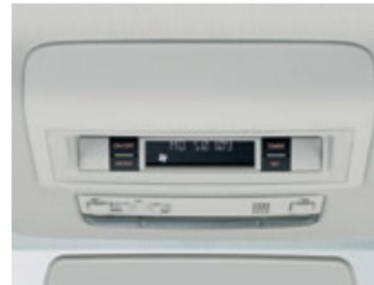
Le chauffage d'appoint à eau. Les versions Amarok équipées des climatisations "Climatronic" peuvent, en option, être dotées d'un chauffage d'appoint à eau qui préchauffe le moteur et augmente la température intérieure de l'habitacle. L'unité de commande est intégrée à la console de pavillon, à portée de main, et le chauffage d'appoint à eau peut aussi être commandé à l'aide de la télécommande radio.
