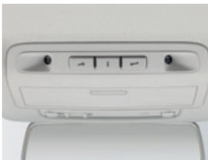
**Le système d'alarme antivol.** En plus du dispositif de surveillance de l'habitacle, il comprend un anti-démarrage électronique, une sirène d'alarme et des systèmes anti-effraction et anti-remorquage.
