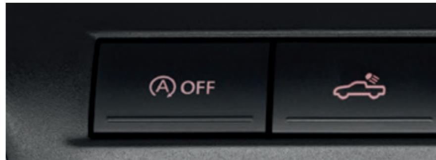
**Le système Start-Stop.** Il rend le véhicule moins gourmand et donc moins polluant. Dans les embouteillages ou aux feux rouges, il suffit de relâcher l'embrayage et de se mettre au point mort pour que le moteur se coupe. Pour repartir, vous n'avez qu'à réembrayer. Dans le cas de la boîte automatique 8 rapports, laissez le pied sur la pédale de frein pour que le moteur se coupe. Il se rallumera automatiquement dès que vous la relâchez.
