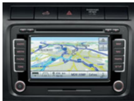
Le système de radionavigation "RNS 510". Disposant d'un écran tactile couleurs 16/9, d'un disque dur de 30 Go, d'un lecteur de carte SD et d'un lecteur de CD compatible MP3, il peut être géré par commande vocale via le volant multifonction.
