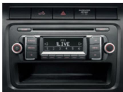
La radio "RCD 210". Cette radio CD dispose d'un affichage des stations RDS, d'un lecteur de CD compatible MP3, d'une interface pour pré-équipement téléphone mobile et de deux haut-parleurs de 20 watts.
