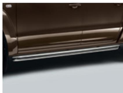
Les tubes de seuil. En acier inoxydable poli d'un diamètre de 76 mm, ils confèrent à l'Amarok une allure sport. Livrés avec fixations, les tubes de seuil se montent facilement grâce aux points d'ancrage, de série sur le véhicule.
