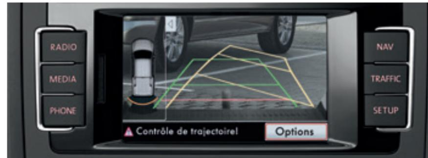
La caméra de recul "Rear Assist". La vue arrière du véhicule s'affiche sur l'écran des systèmes de radionavigation "RNS 315" ou "RNS 510", et aide le conducteur lors des manœuvres de stationnement.
