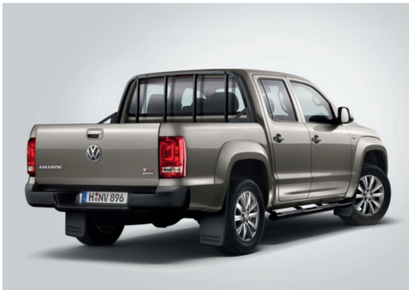
**La grille de protection de vitre arrière.** Cette grille de protection noire très robuste offre une protection efficace contre les dommages pouvant être provoqués par le chargement. Elle est fixée sur le bord de l'espace de chargement.
