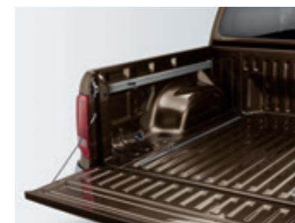
Le système de rails latéraux. Le kit disponible pour les panneaux latéraux de la surface de chargement se compose de deux rails et de quatre œillets d'arrimage qui peuvent être disponibles avec des sangles ou filets de fixation de chargement.
