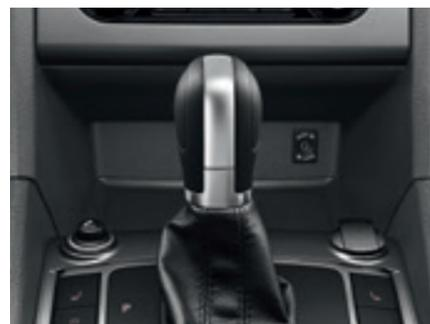
L'interface AUX-IN. Des équipements audio, tel qu'un lecteur MP3 peuvent être raccordés. La gestion des fonctionnalités s'effectue via l'appareil connecté. De série sur les systèmes de radionavigation "RNS 315" et "RNS 510".
