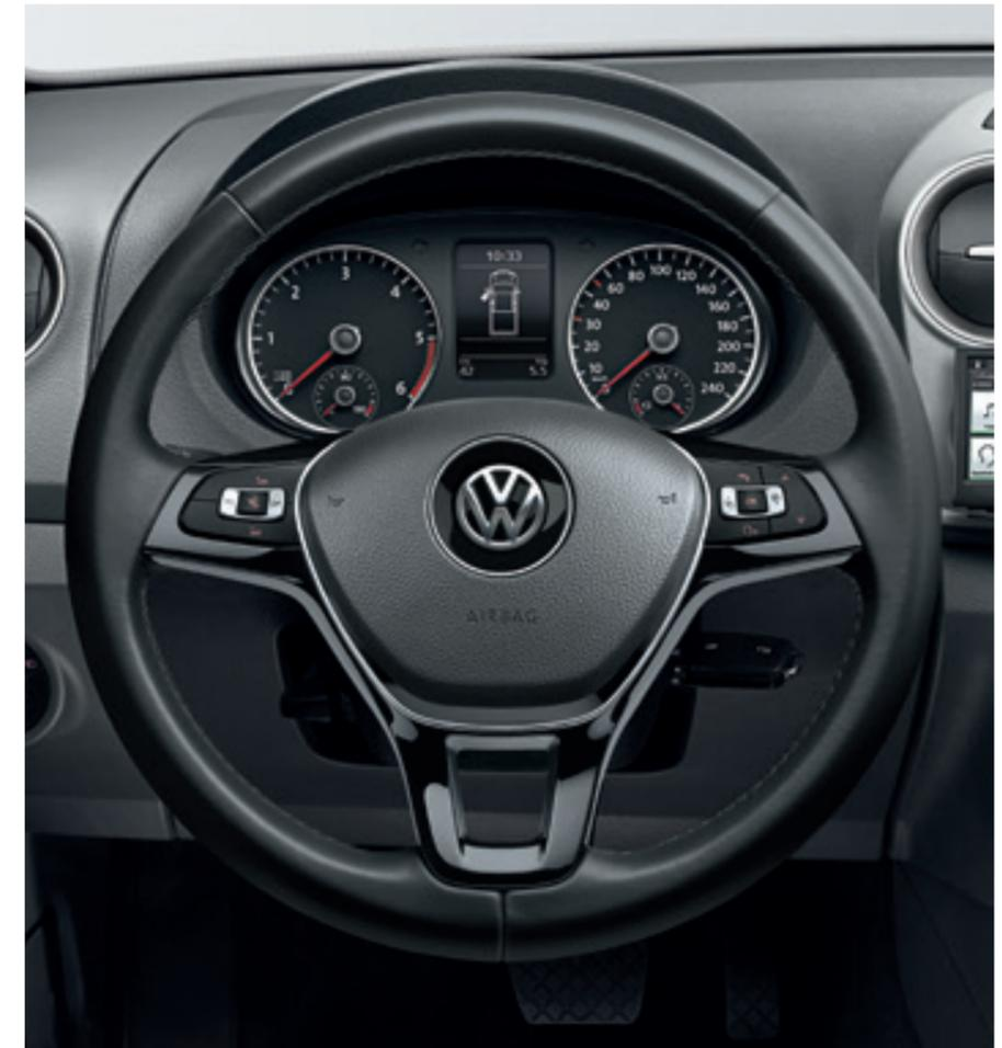
Le volant multifonction. Revêtu de cuir, il permet de commander toute la gamme de radios disponible, le système de radionavigation ainsi que le système mains libres pour téléphone mobile, grâce à ses commandes intégrées.
