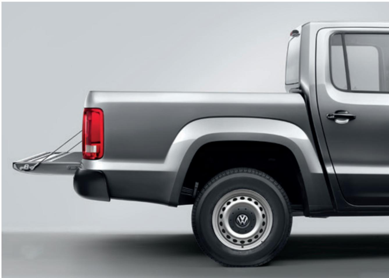
**Les hauteurs du seuil de chargement et de la ridelle.** La faible hauteur du seuil de chargement (780 mm) permet de charger et décharger aisément. La ridelle d'une hauteur de 508 mm permet de transporter des marchandises encombrantes.
