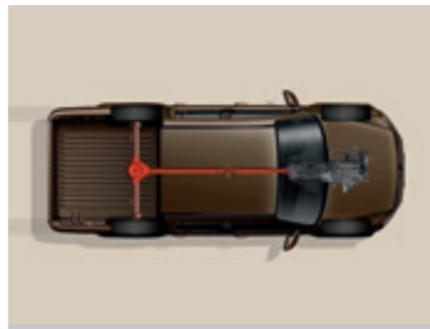
**La propulsion.** La force motrice est transférée à l'essieu arrière via un arbre à cardans pour une excellente maniabilité. L'entraînement 4x2 est conçu à la fois pour la route et le tout-terrain.
