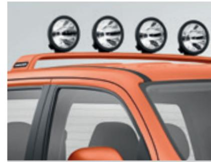
**La rampe d'éclairage.** De couleur carrosserie, elle intègre 4 projecteurs ronds sur le toit, en option. Ceux-ci prennent en charge la fonction de feux de route à la place des phares avant inactifs dans ce cas.
