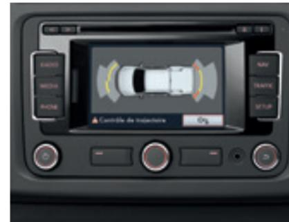
Le ParkPilot. Le système aide le conducteur à se garer. Des signaux sonores indiquent la distance restante à l'arrière du véhicule. De plus, l'écran de la radio "RCD 310", ou des systèmes de radionavigation "RNS 315" et "RNS 510", fournit une information visuelle sur la distance par rapport à l'obstacle. Sur l'Amarok Double Cabine Trendline et l'Amarok Double Cabine Highline, la distance à l'avant s'affiche également.
