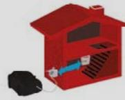
Prise de recharge extérieure sur le mur d'un bâtiment à 15m maximum du tableau électrique existant qui est placé dans le même bâtiment.
