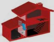
La prise de recharge et le tableau électrique sont dans la même pièce, sans obstacles entre les deux (type mur...).
