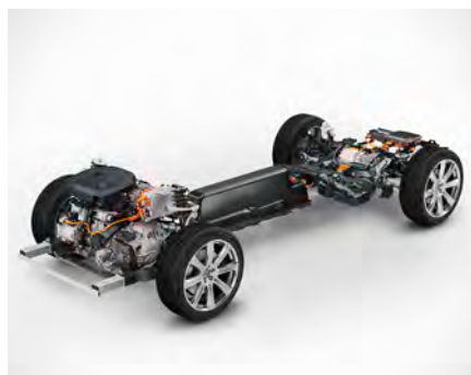
L'emplacement de la batterie permet d'abaisser le centre de gravité de votre Volvo pour la rendre stable, bien campée sur la route et confortable.
