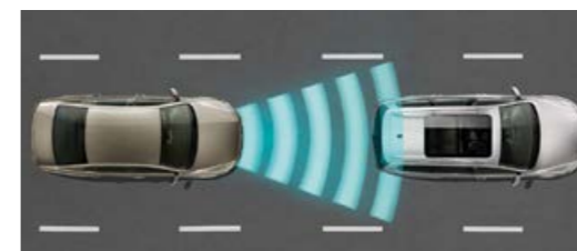
Régulateur de vitesse adaptatif ACC
