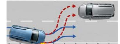
Système de freinage automatique post collision
