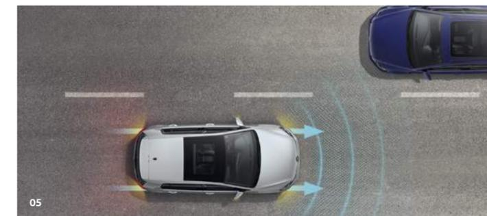
**04 Assurez votre sécurité mais aussi celle des autres : Le système de surveillance périmétrique "Front Assist" avec fonction de freinage d'urgence en ville et détection des piétons** peut aider à réduire les dégâts causés par un accident imminent ou, dans l'idéal, à éviter l'accident. Il détecte les piétons et les autres obstacles sur la chaussée et avertit le conducteur à temps.<sup>1)</sup> En l'absence de réaction de ce dernier, le véhicule déclenche un freinage d'urgence. De série.
