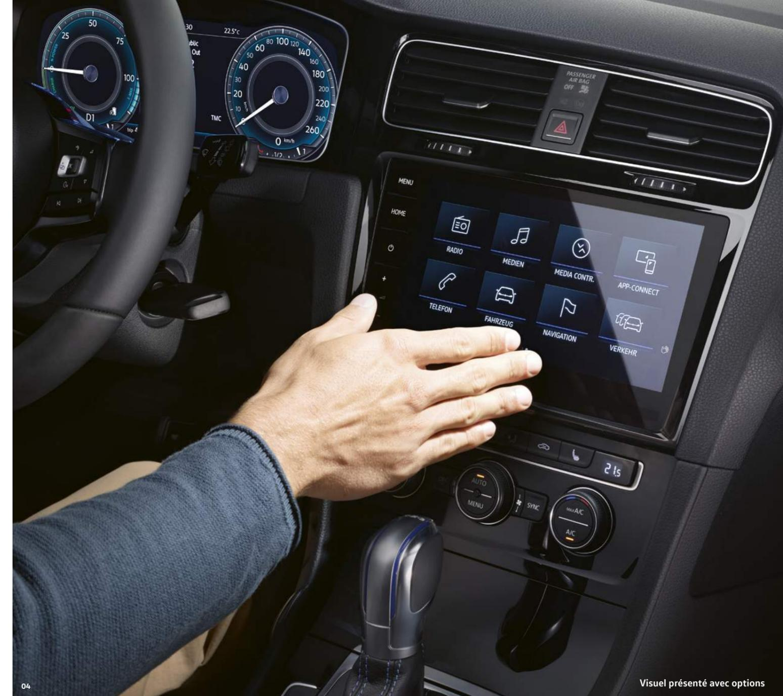
**04** La commande gestuelle (Gesture Control) novatrice vous permet d'utiliser le systeme d'infotainment et de navigation "Discover Pro" de maniere encore plus simple et confortable. D'un simple mouvement de la main, vous pouvez par exemple changer de radio et ce, sans toucher l'ecran.
