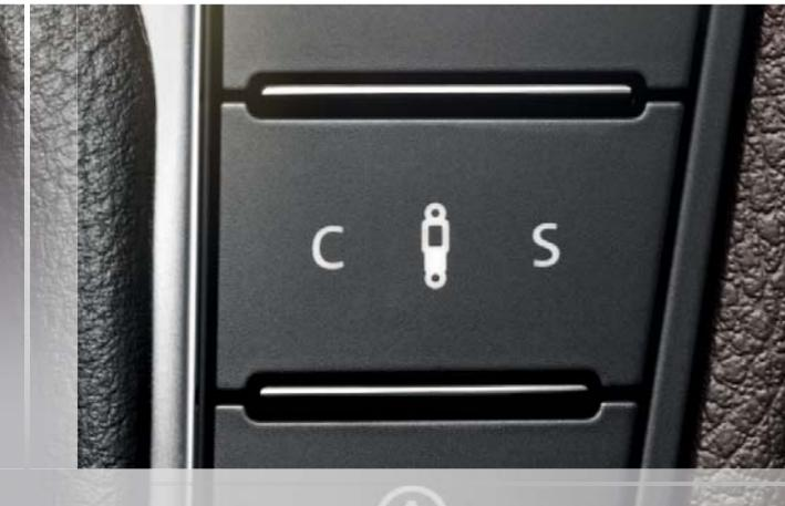
La commande de la régulation adaptative de châssis DCC se trouve à côté du levier de vitesses. Le conducteur peut choisir entre trois réglages de base : 'SPORT', 'NORMAL' et 'CONFORT'.
