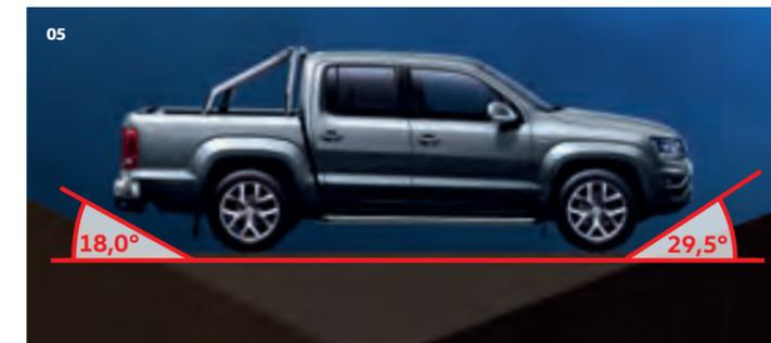
05 Angles d'attaque et de sortie ; profondeur de gué
