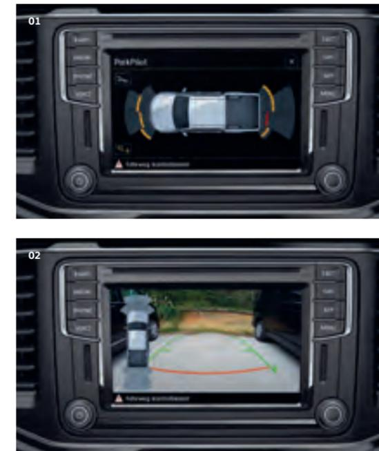
**01 ParkPilot.**<sup>4)</sup> Pendant vos manœuvres de stationnement, il vous indique, par des signaux sonores, la présence d'obstacles devant et derrière votre véhicule, dont la distance sera visible sur l'écran dédié.<sup>5)</sup> Sur la finition Trendline, le ParkPilot (en option) contient un radar de recul, mais pas de radar à l'avant. | TL | CL | CY | CA | AV |
