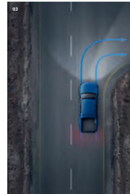
**03 Projecteurs antibrouillard avec éclairage statique d'intersection.** Ils vous assurent une visibilité optimale par mauvais temps. Lors des changements de direction, le projecteur situé à l'intérieur de la courbe éclaire le bord de la route. | TL | CL | CY | CA | AV |
