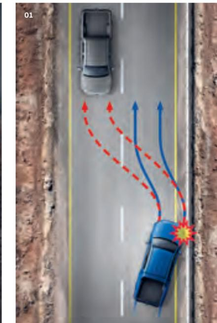
**01 Système de freinage automatique post-collision.**<sup>4)</sup> En cas de collision, il initie le freinage pour prévenir idéalement les collisions secondaires. Après une courte décélération, le véhicule freine progressivement jusqu'à 10 km/h. Le conducteur peut reprendre le contrôle à tout moment. | TL | CL | CY | CA | AV |
