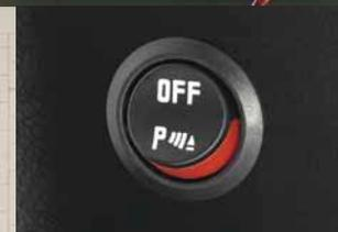
**Interrupteurs de désactivation des capteurs arrière**
