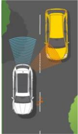
**Détecteur d'angle mort** : Si le système détecte un véhicule dans l'angle mort, un symbole LED d'allume sur le miroir du rétroviseur latéral. Il clignotera si votre clignotant est activé.
