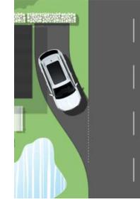
**Manoeuvre Assist:** Il diminue le risque de collision quand la voiture recule (de 1,5 à 10 km/h). Si un obstacle (statique ou mobile) se trouve derrière la voiture, le frein s'active automatiquement.
