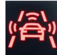
**Emergency Assist:** Si le Lane Assist détecte l'absence des mains du conducteur sur le volant, même après un signal d'alerte, il ralentit la voiture jusqu'à l'arrêt en la maintenant dans la voie, avec les feux de détresse allumés.
