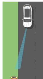
**Reconnaissance des panneaux de signalisation:** Reconnaît les panneaux jusqu'à 50 mètres devant le véhicule et les affiche sur le combiné d'instrumentation.
