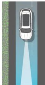
**Assistant de maintien dans la voie (Lane Assist):** Si votre véhicule s'approche trop du marquage latéral, une correction active de trajectoire s'effectue au niveau de la direction pour éviter tout risque de collision.
