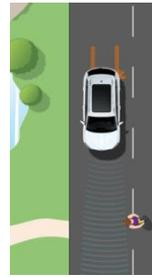
**Protection de piétons:** Préviend de la collision avec des piétons. Un radar scanne l'avant de la voiture et détecte les piétons. Cette fonction est active de 10 à 60 km/h. Au-delà de 30 km/h, un message s'affiche sur le combiné d'instruments.
