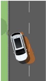
**Freinage anti-multicollisions:** En cas de collision, le freinage s'active pour amener le véhicule à une vitesse de 10 km/h pour réduire l'impact de collisions additionnelles en cas de perte de contrôle du véhicule.
