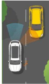
**Détecteur d'angle mort:** Si le système détecte un véhicule dans l'angle mort, un symbole LED d'allume sur le miroir du rétroviseur latéral. Il clignotera si vous clignotant est activé.
