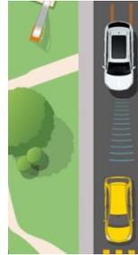
**Freinage d'urgence (Front Assist):** Si vous approchez trop rapidement du véhicule qui vous précède, le système vous alerte avec un signal sonore et visuel. En cas de besoin, le système initie un freinage approprié, jusqu'à l'arrêt complet si nécessaire.
