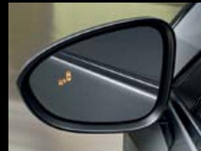
**Alerte de présence dans l'angle mort.** Composé essentiellement d'un rétroviseur extérieur intelligent, il surveille les voies adjacentes et affiche un avertissement si un autre véhicule se trouve dans votre angle mort. Cette option est disponible sur toute la gamme de véhicules et fonctionne jusqu'à une vitesse de 140 km/h.
