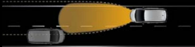
**Assistant feux de route (HBA).** Le système HBA est également inclus dans l'AFL+. Il rend la conduite de nuit plus sûre et plus facile grâce à un passage automatique des feux de route aux feux de croisement lorsque la présence d'un autre véhicule est détectée. Il repasse en feux de route dès que la voie est libre.
