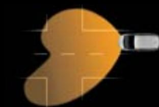
**En ville (30 à 55 km/h).** Faisceau de lumière plus large et abaissé. Sensible à la vitesse du véhicule et à l'éclairage urbain.
