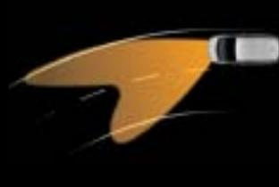
**Dans un virage (quelle que soit la vitesse).** En fonction de l'angle de braquage et de la vitesse du véhicule, les phares avant pivotent jusqu'à 15° le temps du virage.
