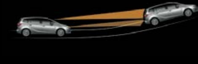
**Système d'ajustement intelligent des feux (ILR).** À une vitesse supérieure à 50 km/h, l'ILR étend la portée des phares d'environ 350 mètres. Afin de ne pas éblouir les autres conducteurs, l'ILR ajuste automatiquement sa diffusion. Et si vous vous trouvez sur une route vallonnée, l'ILR règle automatiquement la hauteur des phares pour augmenter votre visibilité.
