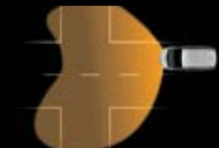
**En zone piétonne (jusqu'à 30 km/h).** Une diffusion de lumière plus large (8 degrés supplémentaires à gauche et à droite) permet de distinguer les dangers potentiels.
