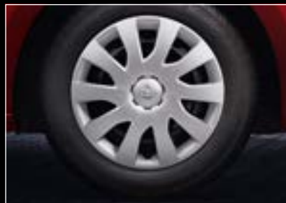
Jante tôleée 16" avec enjoliveur, pneu 205/65 R 16 ou 215/65 R 16 selon les versions 2
