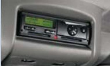
**Tachygraphe numérique.** Simple d'utilisation pour le conducteur. Enregistre fidèlement le temps de conduite et de repos à des fins de regroupement et d'analyse des données de gestion de parc automobile.
