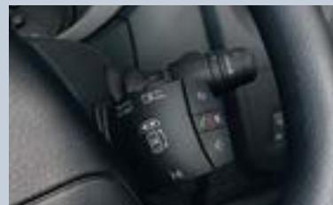
**Commandes radio au volant.** Permet d'éviter toute distraction au conducteur, en pilotant depuis le volant le système multimedia.
