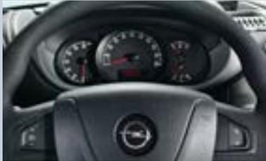
**Régulateur-Limiteur de vitesse.** Commandé au volant, le régulateur de vitesse permet également au conducteur de sélectionner une vitesse maximum temporaire.
