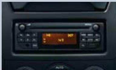
**CD 16 BT et USB.** Le radio CD 16 MP3 (2 x 15 W) avec afficheur intégré dispose des commandes au volant, d'une connectivité Bluetooth®, d'une prise aux-in et de deux ports USB.
