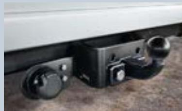
**Crochets d'attelage.** Disponible en option ou en accessoire, notre gamme de crochets d'attelage (simples ou mixtes) vous offre encore plus de flexibilité dans vos chargements en vous permettant de tracter jusqu'à 3,5 tonnes à l'arrière.
