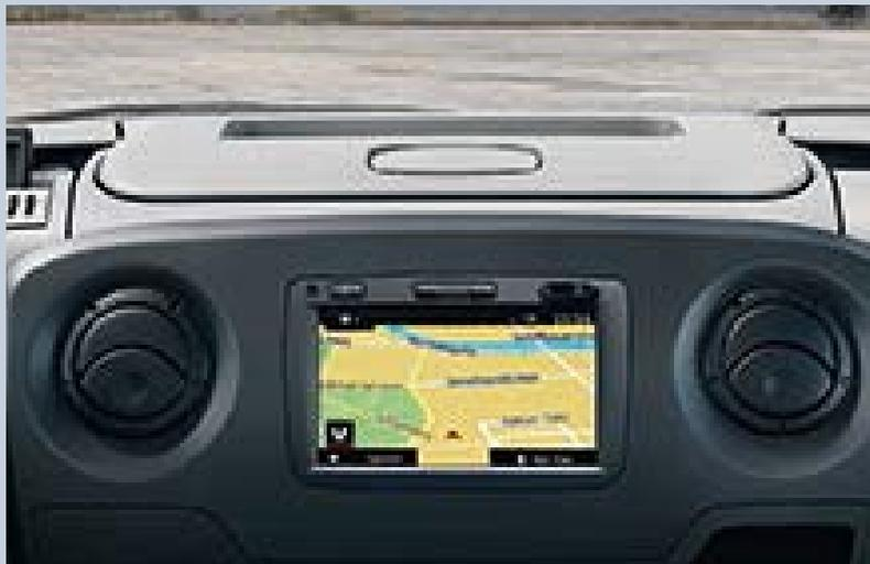
**Navi 50 IntelliLink.** Ce système de navigation est doté d'un écran tactile couleur 7 pouces (17,8 cm), positionné de façon optimale sur la console centrale. Il offre une navigation dynamique grâce aux modes 2D ou « bird-view » et à l'info trafic TMC. La cartographie peut être mise à jour via USB.
