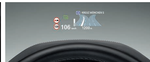
Affichage Tête Haute HUD couleur. Il projette les informations de conduite essentielles directement dans le champ de vision du conducteur. Vous restez ainsi concentré sur la route. Il affiche notamment la vitesse instantanée de la voiture et les instructions de navigation, les indications de limitation de vitesse avec interdiction de dépassement (option), les messages de l'unité de contrôle et les informations ayant trait aux fonctions d'info-divertissement.
