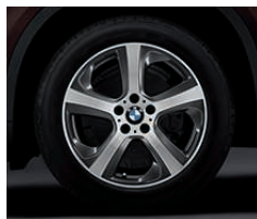
Jantes en alliage léger 19" (48 cm) style 490 à rayons en étoile, BMW EfficientDynamics. Dimensions : 9 J x 19, pneumatiques 255/50 R 19.
