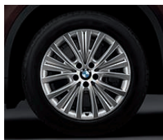
Jantes en alliage léger 19" (48 cm) style 448 à rayons multiples. Dimensions : 9 J x 19, pneumatiques 255/50 R 19.
