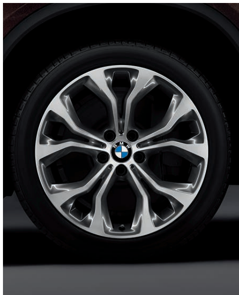
Jantes en alliage léger 20" (51 cm) style 451 à rayons en Y avec monte pneumatique mixte. Dimensions : 10 J x 20 à l'avant, pneumatiques 275/40 R 20 ; 11 J x 20 à l'arrière, pneumatiques 315/35 R 20.
