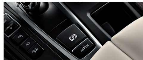
Le frein de stationnement avec fonction de maintien automatique du véhicule à l'arrêt Auto Hold est activé aisément via une touche dans la console centrale. Le frein est automatiquement relâché dès que le conducteur appuie sur la pédale d'accélérateur. La fonction de maintien automatique du véhicule à l'arrêt Auto Hold assiste le conducteur, par exemple en circulation en accordéon ou lors d'un démarrage en côte en empêchant la voiture d'avancer ou de reculer inopinément.
