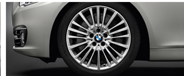
Jantes en alliage léger 19" (48 cm) style 455 à rayons multiples avec pneumatiques RSC permettant le roulage à plat. Dimensions : 8,5 J x 19, pneumatiques 245/40 R 19.
