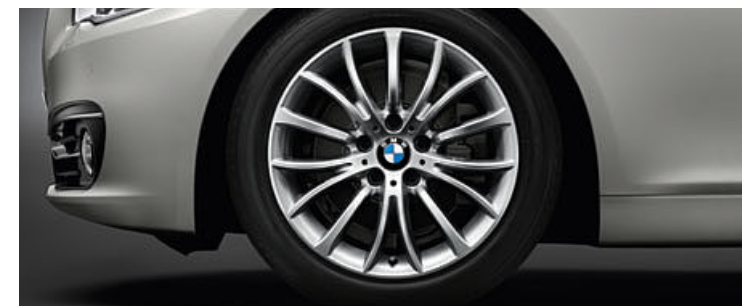
Jantes en alliage léger 18" (46 cm) style 454 à rayons multiples avec pneumatiques RSC permettant le roulage à plat. Dimensions : 8 J x 18, pneumatiques 245/45 R 18. De série sur la Finition Luxury.
