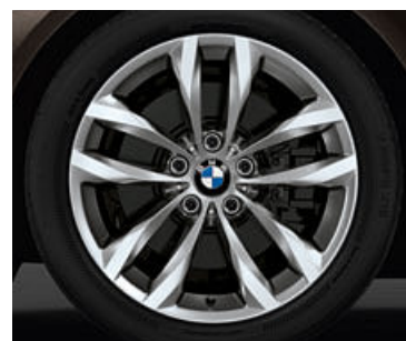
Jantes en alliage léger 18" (46 cm) style 609 à rayons doubles, avec monte pneumatique mixte RSC permettant le roulage à plat. Dimensions : 8 J x 18 à l'avant, pneumatiques 245/45 R 18 ; 9 J x 18 à l'arrière, pneumatiques 275/40 R 18.
