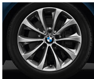
Jantes en alliage léger 18" (46 cm) style 452 Turbine en « Ferricgrau » bicolore avec pneumatiques RSC permettant le roulage à plat. Dimensions : 8 J x 18, pneumatiques 245/45 R 18.
