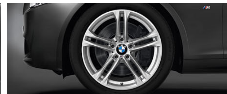
Jantes en alliage léger 18" (46 cm) style 613 M à rayons doubles avec pneumatiques RSC permettant le roulage à plat. Dimensions : 8 J x 18, pneumatiques 245/45 R 18. De série sur la Finition M Sport.
