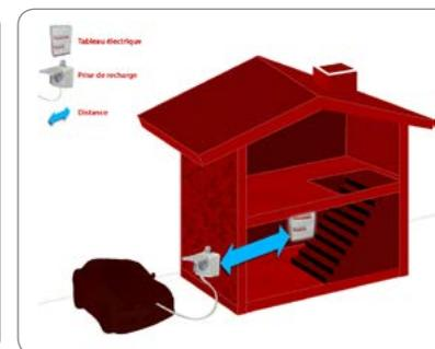
**Configuration 4** : prise de recharge extérieure sur mur d'un bâtiment à 10 m. maximum du tableau électrique existant qui est placé dans le même bâtiment.
