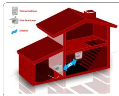
**Configuration 3** : la borne de recharge et le tableau électrique sont dans deux pièces différentes du bâtiment.
