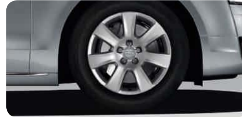
Jantes hiver en aluminium coulé style 7 branches 7,5 J x 18 avec pneus 235/55 R 18 1 , vitesse maximale autorisée 210 km/h, compatibles chaînes-neige
