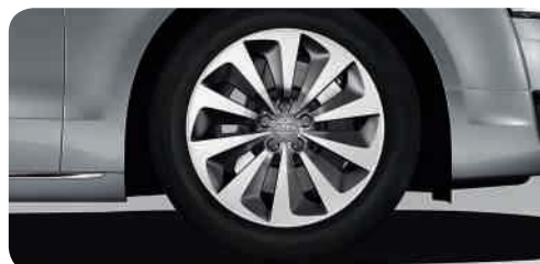
Jantes en aluminium coulé style 10 branches en turbines (style hybrid) gris contrasté, partiellement polies 2 9 J x 19 avec pneus 255/45 R 19 1
