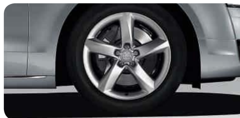
Jantes en aluminium coulé style 5 branches 9 J x 19 avec pneus 255/45 R 19 1
