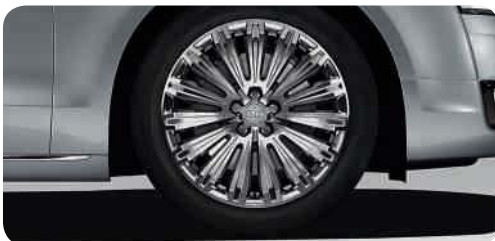
Jantes en aluminium forgé style 15 branches structurées, polies haute brillance 2 9 J x 20 avec pneus 265/40 R 20 1
