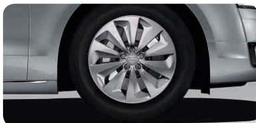
Jantes en aluminium coulé style 10 branches en turbines (style hybrid) 8 J x 18 avec pneus 235/55 R 18 1
