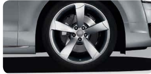
Jantes en aluminium coulé Audi Sport style 5 branches en hélice 9 J x 21 avec pneus 275/35 R 21 1 . Une offre de quattro GmbH
