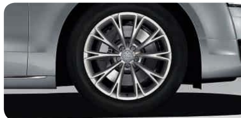
Jantes en aluminium coulé style 10 branches en Y, partiellement polies 2 9 J x 19 avec pneus 255/45 R 19 1
