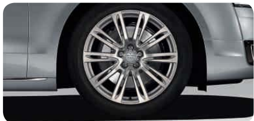
Jantes en aluminium forgé style 10 branches parallèles, partiellement polies 2 9 J x 20 avec pneus 265/40 R 20 1
