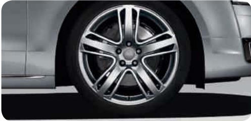
Jantes en aluminium coulé Audi Sport style 5 branches structurées 9 J x 21 avec pneus 275/35 R 21 1 . Une offre de quattro GmbH
