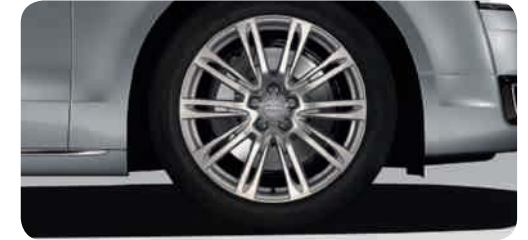
Jantes hiver en aluminium forgé style 10 branches parallèles 9 J x 20 avec pneus 265/40 R 20 1 , vitesse maximale autorisée 240 km/h, non compatibles chaînes-neige
