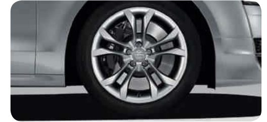
Jantes hiver en aluminium coulé style 5 branches parallèles (style S) 9 J x 20 avec pneus 265/40 R 20 1 , vitesse maximale autorisée 240 km/h, non compatibles chaînes-neige
