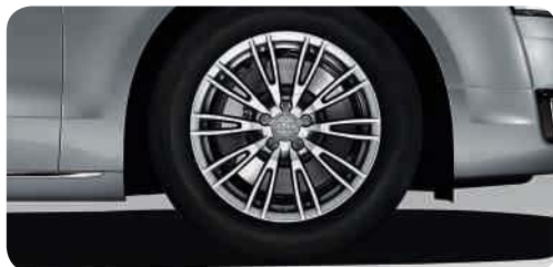
Jantes en aluminium coulé style 10 branches en V 8 J x 18 avec pneus 235/55 R 18 1
